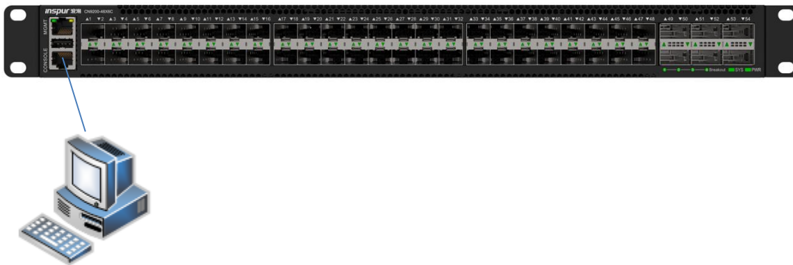
图 4-1 通过 Console 口搭建本地配置环境
